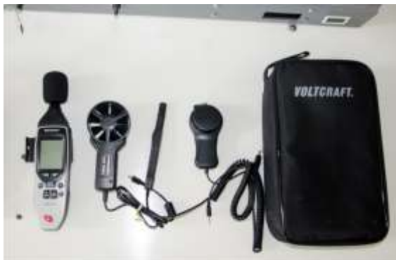
Прилад для вимірювання температури, швидкості руху потоку, рівня шуму VOLTcraft UM5 / 1 100 (5 в 1)
